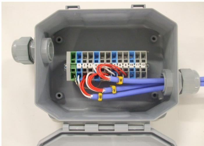
SCS-R: вид изнутри для трёх датчиков температуры Pt100.
